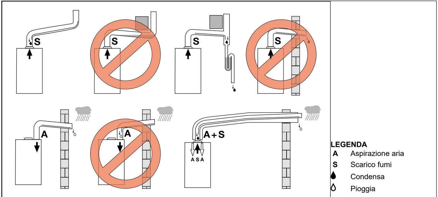
Fig. 9 Esempi di installazione
