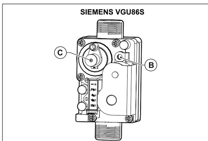
Fig. 26 Regolazione valvola gas
