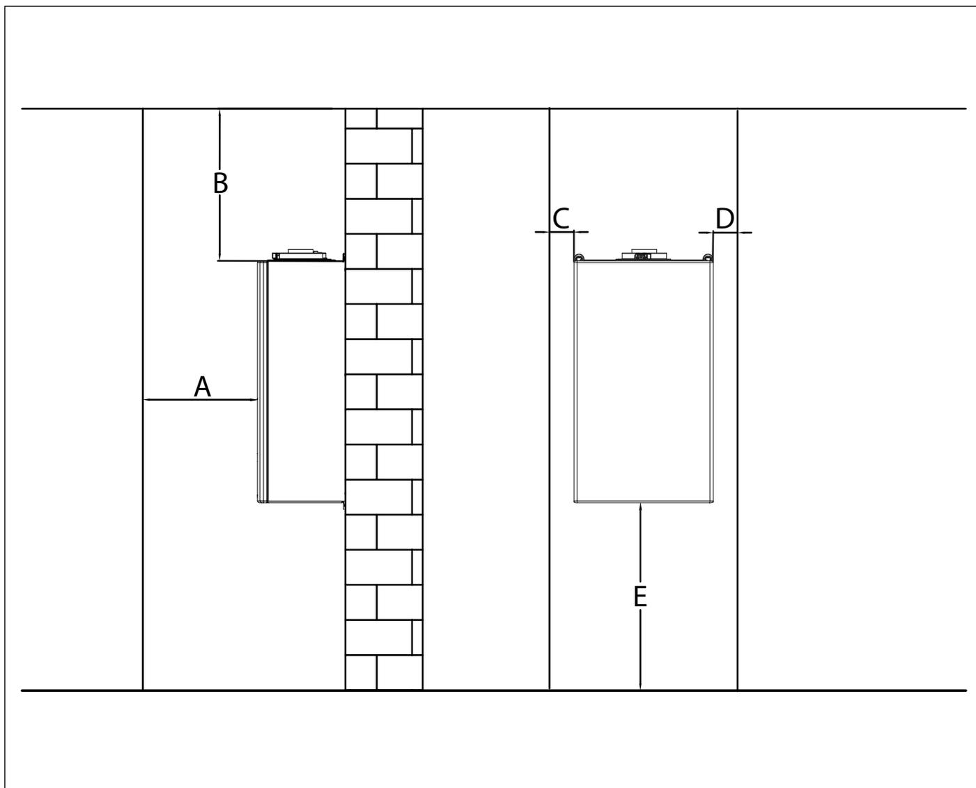
Fig. 6 Distanze minime di installazione
