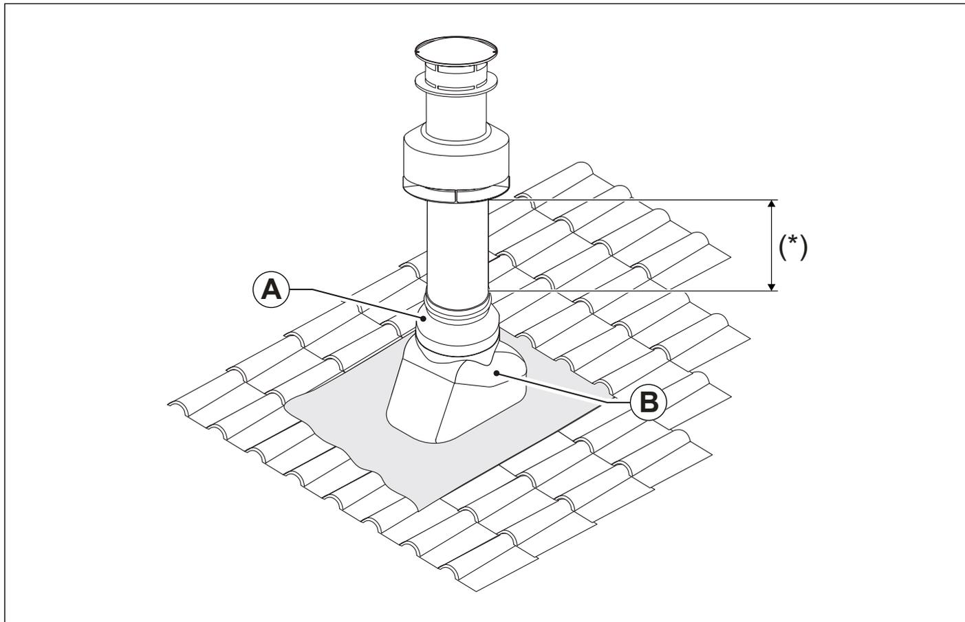
Fig. 13 Installazione camino a tetto
