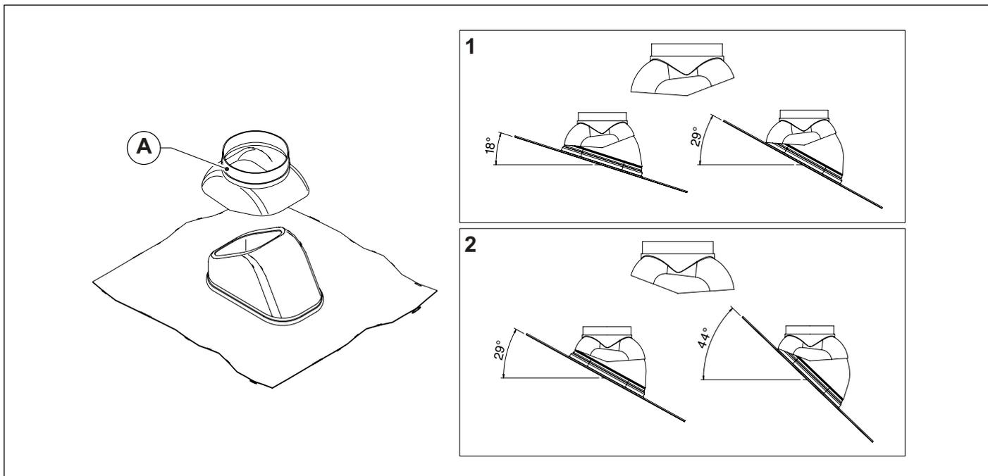
Fig. 12 Tegola per tetti inclinati
