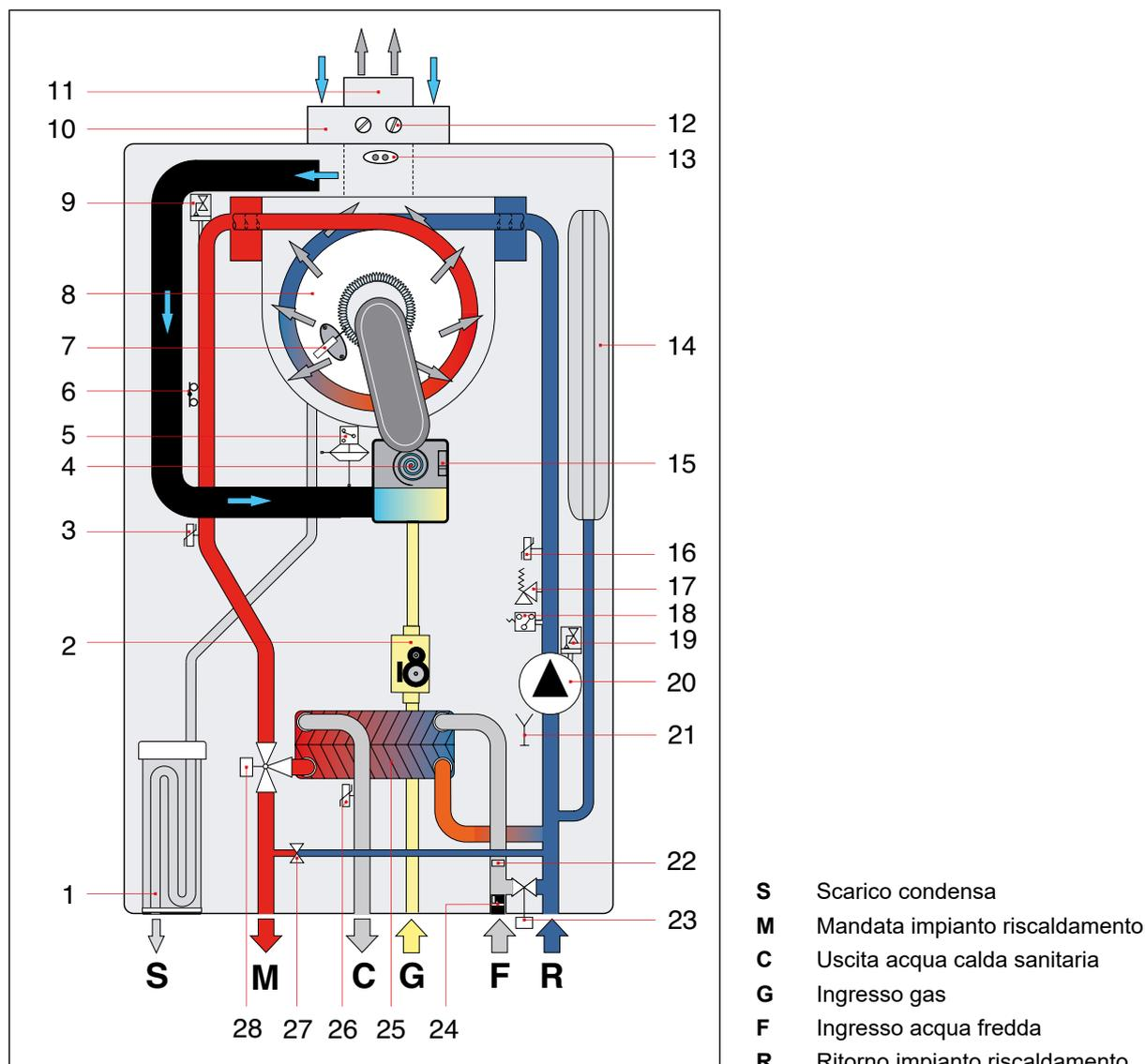
Fig. 4 Schema idraulico
