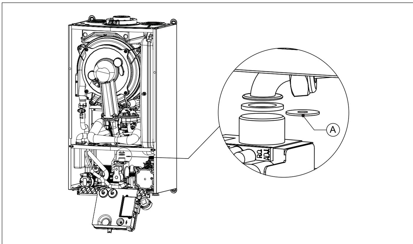
Fig. 25 Sostituzione diaframma gas
