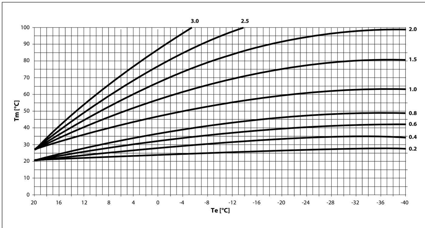
Fig. 22 Curve di termoregolazione
