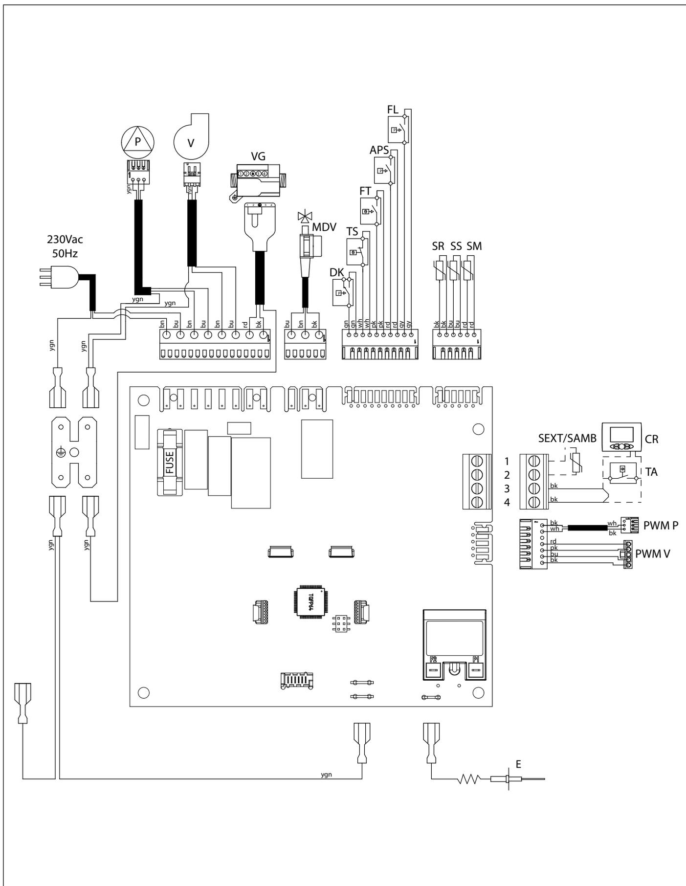
Fig. 24 Schema elettrico KC
