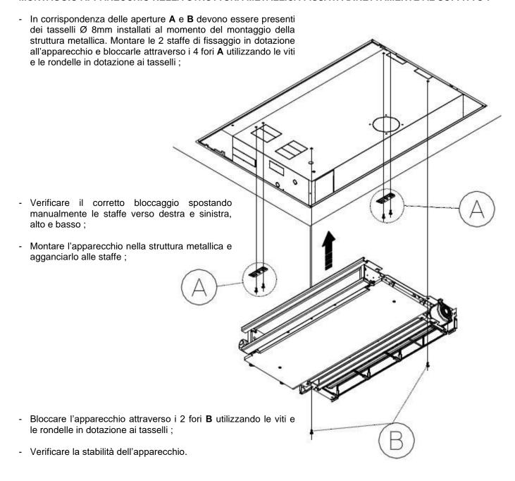
MONTAGGIO APPARECCHIO NELLA STRUTTURA METALLICA FISSATA CON DEGLI ANCORAGGI STACCATI DAL SOFFITTO :
