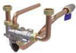
El kit solar para calderas instantáneas permite de bypassar la caldera en el caso de que la temperatura del agua del tanque solar sea mayor de 48°C. Está constituido por una válvula desviadora termostática y por una mezcladora termostática regulable, integradas entre ellas.
